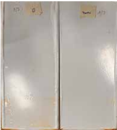
Hình 1. Mẫu thử nghiệm ngâm muối theo ASTM B895.
